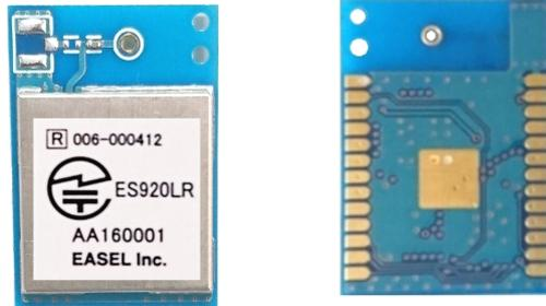
LoRa 変調は、従来の 920MHz 帯を使用し、より長距離無線を可能とする新たな無線方式です。スペクトラム拡散(チャープ信号)を行い、従来受信できなかったレベルの電波までキャッチし、電波条件が整えば **30Km 以上の通信**も行えます。
